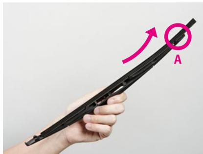
② 写真のように、A部のストッパーからワイパーラバーを一度引き出し、戻すようにB部の爪に通します。
